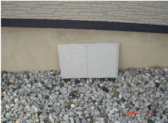
知り合いの建設会社より外壁パネルの切れ端を貰ってきて、経過を見るために右半分にはサガンコートを施工した。
